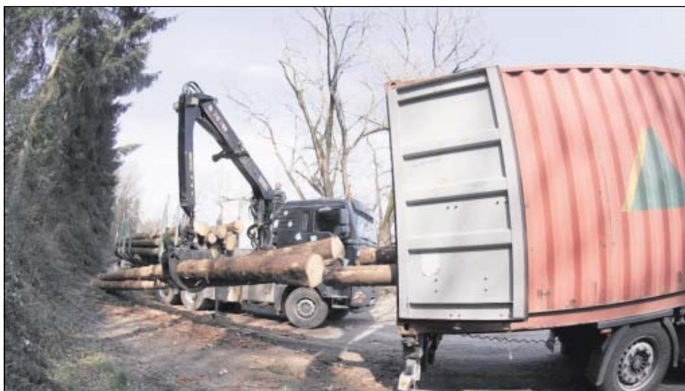
Ungefähr 28 Festmeter Holz passen bei einer genormte Stammlänge von 11,80 Metern in den roten Container, der nach Asien verschifft wird. Fotos: Ted Jones
