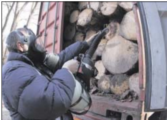
Mit einem Hochdruckbestäuber wird das Holz im Container begast. Dabei werden Käfer, Eier und Larven getötet.
